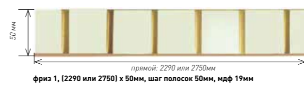
фриз 1, (2290 или 2750) x 50мм, шаг полосок 50мм, мдф 19мм
